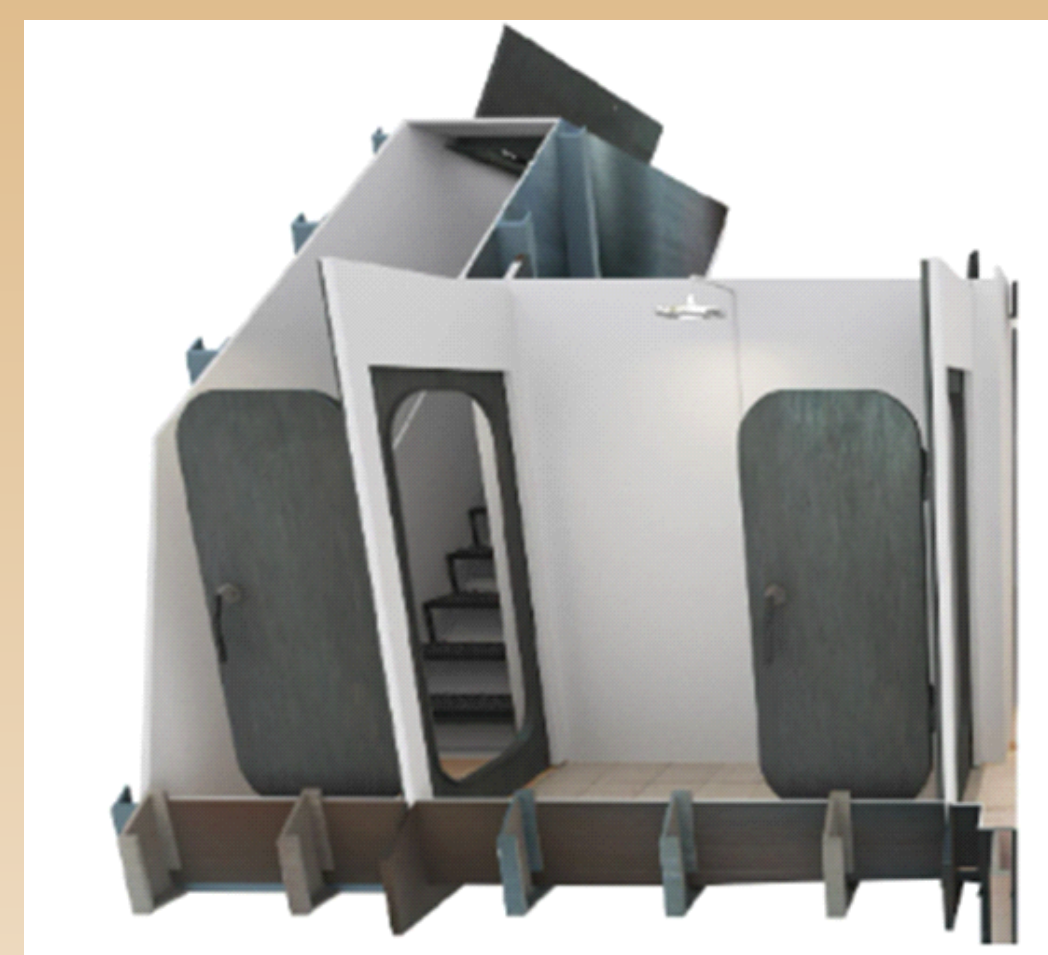
MUD ROOM , piccolo ambiente di decontaminazione con doccia e box smaltimento indumenti, dotato di porta d'ingresso blindate, a chiusura ermetica e tenuta stagna antigas che separano dal vano scala e dalla cellula di sopravvivenza
