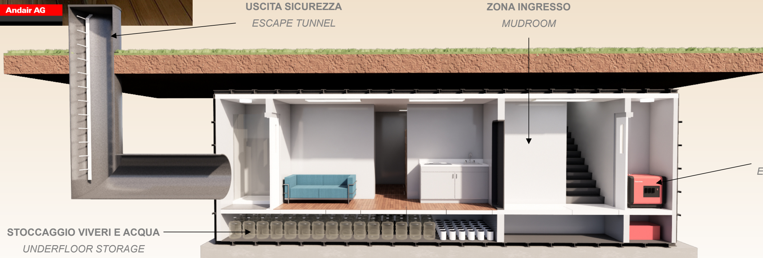
MUD ROOM , piccolo ambiente di decontaminazione con doccia e box smaltimento indumenti, dotato di porta d'ingresso blindate, a chiusura ermetica e tenuta stagna antigas che separano dal vano scala e dalla cellula di sopravvivenza
